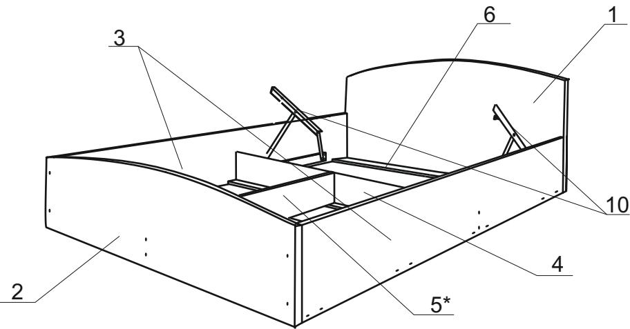
Крепить к царгам кровати (дет.3) поперечные упоры шириной 8см (дет. 6) с помощью конфирматов 7x50 (Ф-№1). Внутрь кровати кладем дно (дет. 7) без ручки (в нишу с подъемным механизмом), затем крепим ребро жесткости (дет. 4) с помощью конфирматов (Ф-№1) и ключа (Ф-№10).
