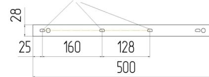
На верхний торец ребра (ребер) жесткости прибиваем пластиковые подпятники (Ф-№7) с помощью гвоздей (Ф-№12) в местах соприкосновения ребер с металлической решеткой.
