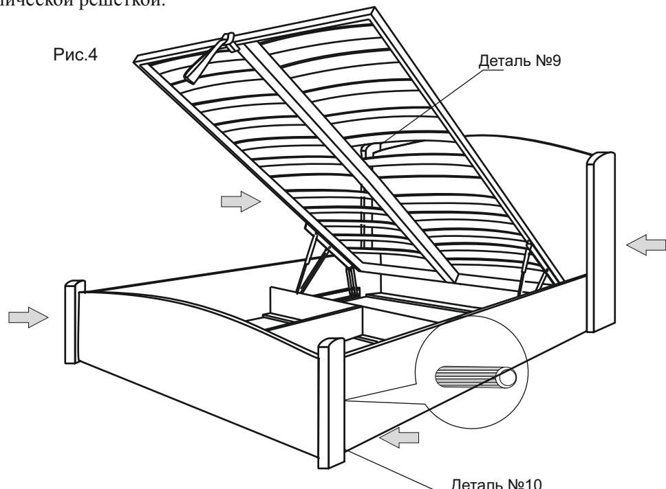
Затем к спинкам (дет.№2,3) при помощи шкантов (Ф-№4) с kleem (Ф-№5), не допуская зазора, присоединить декоративные накладки (дет.11,12) (см. рис.4), выдержать 24 часа, не прилагая механических усилий.
